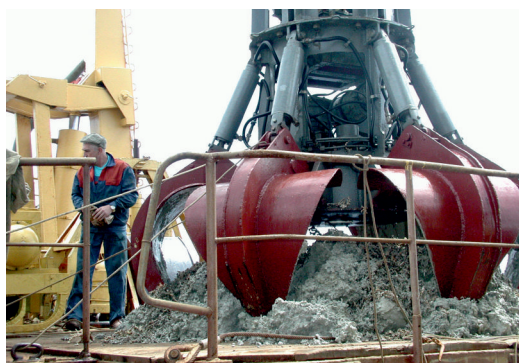
Гидравлический грейфер с ТВ контролем (для скальных пород)
